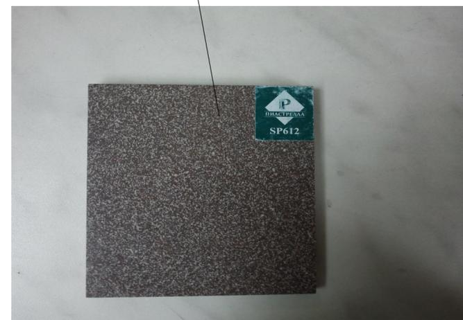
Фиброцементная фасадная плитка Олис-Стоун RAL 5025 (аналог SP612)
